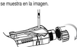
5. Coloque la nueva punta de destornillador en el lugar que se muestra en la imagen.
